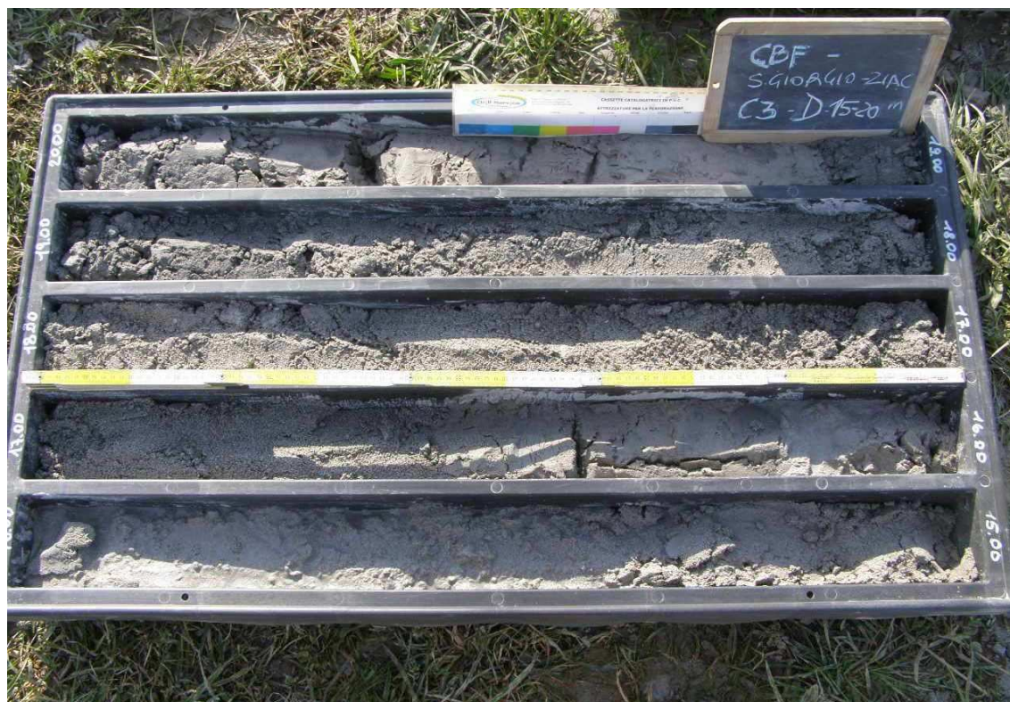
Sondaggio C3, Cassetta D: da 15.0 a 20.0 metri.
