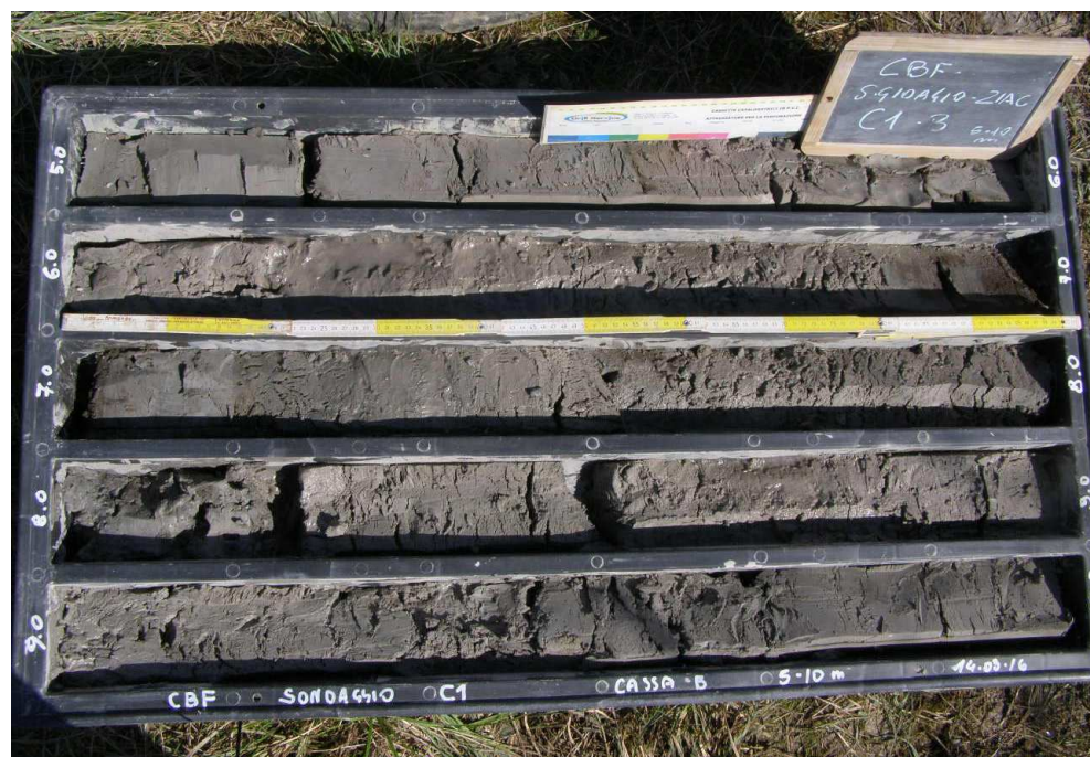
Sondaggio C1, Cassetta A: da 0.0 a 5.0 metri.
