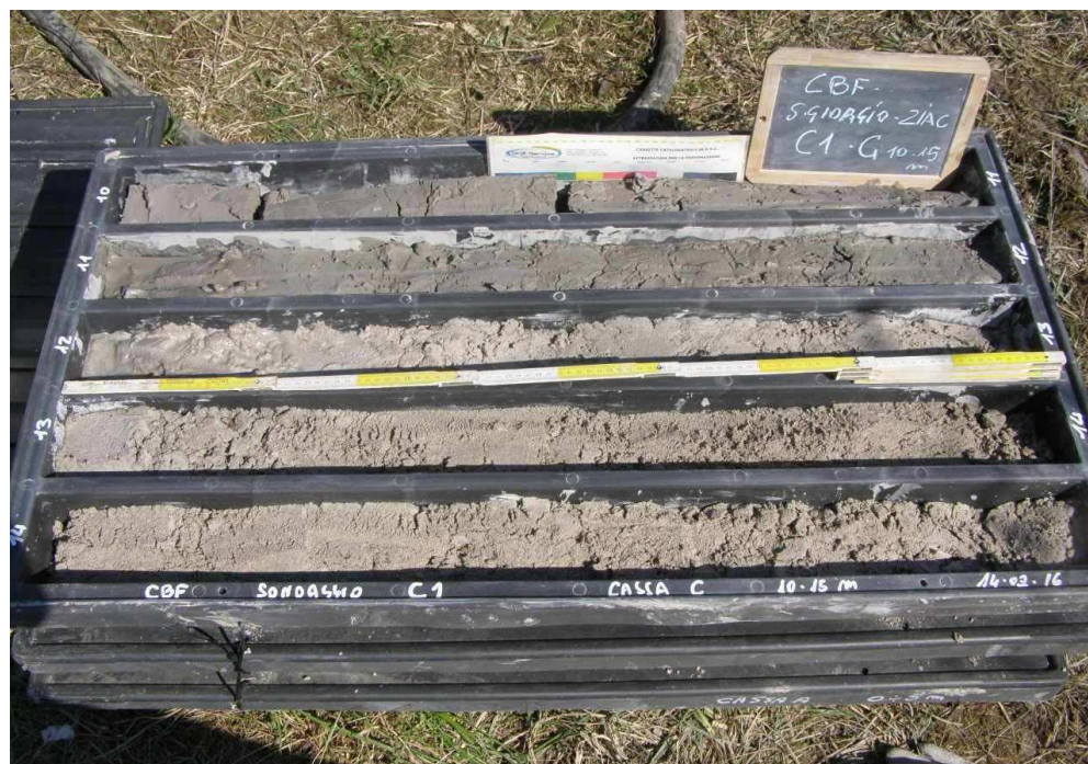
Sondaggio C1, Cassetta C: da 10.0 a 15.0 metri.
